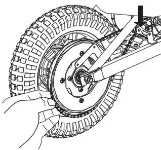
**5** Instale la cadena en el piñón de la rueda trasera. Deslice el eje de la rueda en las ranuras del marco. Empuje el tensor de la cadena hacia abajo para crear holgura en la cadena. Apriete a mano las contratuercas del eje trasero.
