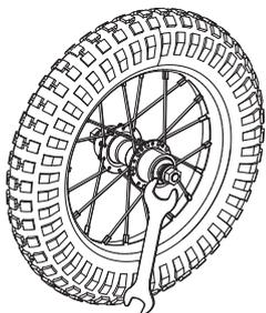
**2** Retire las tuercas en ambos lados del eje delantero con una llave de 15 mm y luego retire las arandelas de seguridad del eje.
