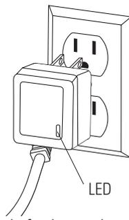
**1** Enchufe el cargador en un tomacorriente de pared. La luz del cargador debe estar verde.
