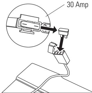
**6** Retire el fusible y reemplácelo por uno nuevo de igual amperaje. Cierre la tapa del fusible y vuelva a colocar la tapa de la batería, el carenado y la tapa de plástico.
