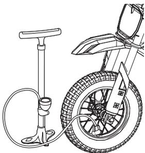
**1** Usando una bomba para neumáticos de bicicleta con válvula Schrader, infle el neumático delantero al PSI correcto indicado en la pared lateral del neumático.
