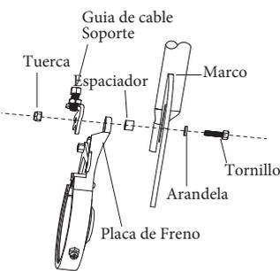
**8** Instale el soporte de la guía del cable en el marco y la placa del freno con un perno, arandelas y tuerca. No apriete
