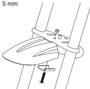
**1** Alinear la defensa con el agujero de la horquilla e inserte el tornillo. Apriete con fuerza usando una llave de 10 mm y una llave Allen de 5 mm.
