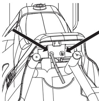
**3** Con una llave Allen de 5 mm, afloje los dos (2) pernos debajo de la parte trasera del asiento y retire el carenado.
