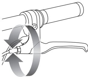
**1** Para ajustar el juego de cable de freno, rosca el Ajustador de la palanca de freno de 0 a 1/4 a 1/2 vuelta hasta que se logre el ajuste de los frenos deseada. Ajustes la mayoría están completos en este paso. Si freno todavía necesita ajuste, proceda al paso 2.
