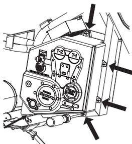
**4** En el lado opuesto del puerto del cargador, ubique y retire los cinco (5) tornillos Phillips y las tuercas de seguridad de la cubierta de la batería con un destornillador Phillips y una llave de 8 mm. Separar y quitar la tapa.
