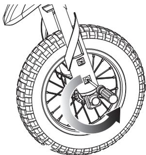
**1** Con un destornillador Phillip, afloje los dos (2) tornillos en las cubiertas de la horquilla (2 por lado) y retire las cubiertas.
