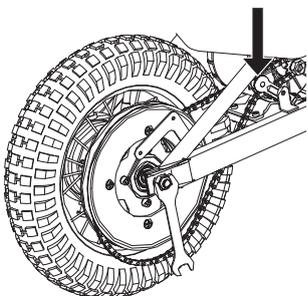
**4** Con dos (2) llaves de 15 mm, afloje el eje. Empuje el tensor de la cadena hacia abajo para aflojar la cadena y quitar la rueda.
