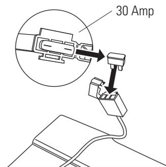
**5** Retire el fusible y reemplácelo por uno nuevo de igual amperaje. Cierre la tapa del fusible y vuelva a colocar la tapa de la batería, el carenado y la tapa de plástico.
