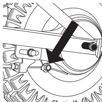
**2** Si el freno tiene demasiada holgura, use una llave de 10 mm para aflojar el cable de anclaje del freno para un ajuste adicional y vuelva a apretarlo.
