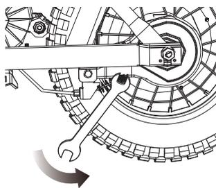
**2** Con una llave de 10 mm, afloje el perno de anclaje del cable del freno y desconecte el cable.
