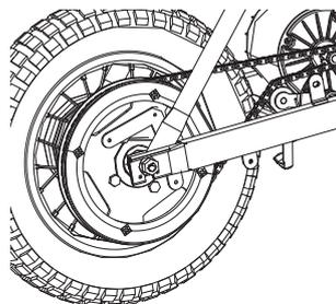
**6** Verifique que la cadena esté correctamente instalada en cada rueda dentada y que el tensor esté correctamente posicionado en la parte inferior de la cadena.
