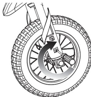
**3** Retire la rueda delantera e instale la rueda de repuesto. Vuelva a colocar las cubiertas de la horquilla.
