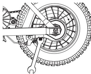
**9** Pase el cable del freno a través del cilindro del ajustador del freno, a través del resorte grande, y dentro del orificio pequeño en el costado del perno de anclaje. Coloque el cable en la ubicación original (como lo indica el ligero acodamiento del cable) y apriételo firmemente.
