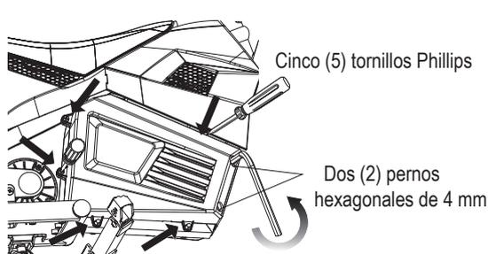
**3** En el lado opuesto del puerto del cargador, ubique y retire los cinco (5) tornillos Phillips y (2) tornillos hexagonales de 4 mm o pernos con una llave Allen de 4 mm. Separar y quitar la tapa.
