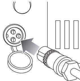
**2** Asegúrese de que el interruptor esté en la posición OFF. Enchufe el cargador en el puerto de carga. La luz del cargador debe a roja durante la carga entonces vuelta a verde cuando la carga es completa.
