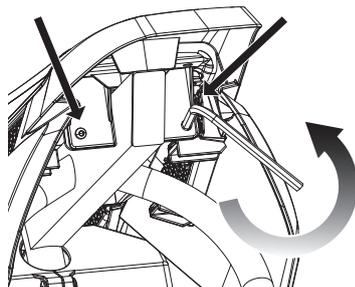
**2** Con una llave Allen de 5 mm y una llave abierta de 10 mm para sujetar las tuercas de seguridad, afloje los dos (2) pernos debajo de la parte posterior del asiento y retire el carenado.
