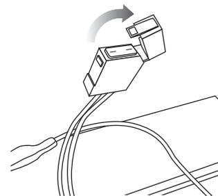
**4** Ubique la caja de fusibles conectada a las baterías. Abra la tapa del fusible para exponer el fusible.
