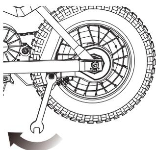
**10** Apriete el perno del soporte de la guía del cable. Apriete las contratuercas en el eje trasero. Pruebe el freno para verificar el correcto funcionamiento antes de conducir. Reajuste según sea necesario.
