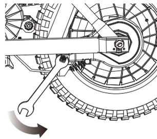
**3** Con (2) llaves de 5 mm, retire el soporte de guía del cable del marco y la placa de freno. Mantenga el espaciador y las arandelas juntas.
