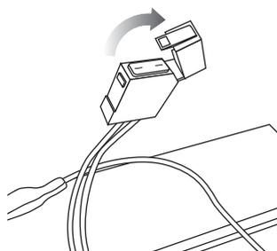
**5** Ubique la caja de fusibles conectada a las baterías. Abra la tapa del fusible para exponer el fusible.
