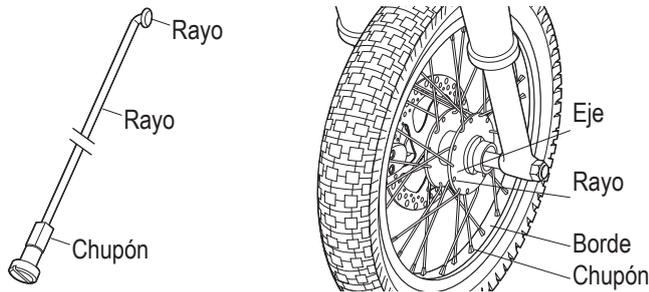
**1** Verificar la tensión de los radios agitando cada uno con sus dedos. El Radio no debe estar suelto en el cubo. Busque cualquier holgura entre el lugar donde el radio se adjunta al cubo. Intente girar el chupón con los dedos. No debería ser posible girar el chupón con la mano. Si uno o más radios está flojo, todos los radios deben verificarse y ser apretados con un llave de radio.
