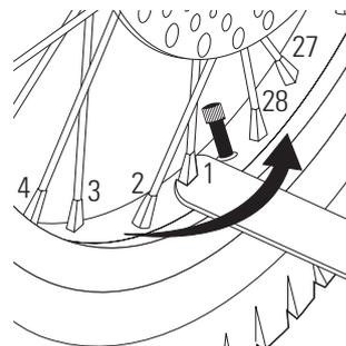
**2** Comience con los radios más cercanos al vástago de la válvula del neumático y apriete los chupones órden exacto de 1/4 a 1/2 vuelta. Un solo vuelta de 1/4 a 1/2 puede no ser suficiente para tensar los radios adecuadamente. No continúe apretando los radios, más de 1/2 vuelta, en secuencia hasta que todos los radios estén apretados.
