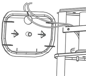
Pase los cables a través de la ranura en la parte superior de la placa. Alinear la placa con los agujeros en la horquilla y el broche de presión en la placa.
