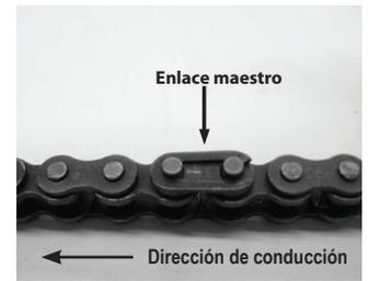
1 Localice el eslabón maestro en la cadena de reemplazo y con un destornillador de cabeza plana, desenganche cuidadosamente el clip de la cadena para quitar la placa de enlace y el enlace del conector.
