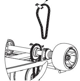
2 Envuelva la cadena alrededor de ambos piñones y tensor de tensión. Inserte el conector a través de la cadena y coloque la placa de enlace sobre el enlace del conector.
