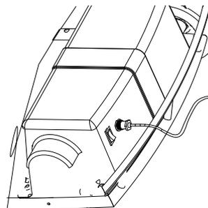
**1** Enchufar el cargador en el puerto de la Avalancha Eléctrica. Asegurarse de que el interruptor esté en posición-off.
