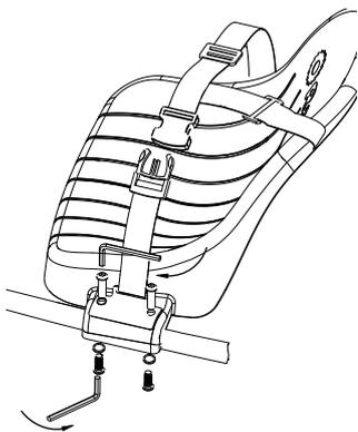
**1** Posicionar el asiento sobre el cuadro y alinearlos con los orificios del cuadro. Alinear los orificios de la fijación del cinturón de seguridad con los orificios del asiento y el cuadro con el conjunto de regazo y hombro a la izquierda y el broche hembra a la derecha. Introducir los tornillos y apretarlos bien.
