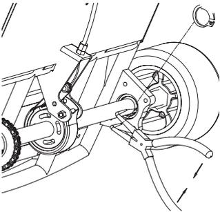
4 Retirar los clips en C ubicados en el eje, entre los dos rodamientos.
