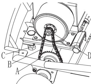
El sistema de transmisión por cadena consta de la rueda dentada del eje de transmisión (A), la cadena (B), el perno de ajuste (C) y la rueda dentada del motor (D)
