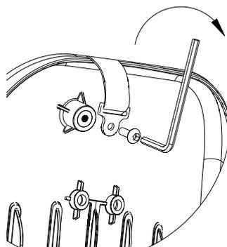
**2** Instalar la fijación del cinturón de hombro en el respaldo del asiento. Introducir y apretar bien.
