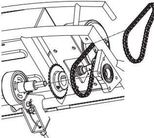
6 Cuando el extremo del eje esté separado del soporte del cojinete, retire el eje.
