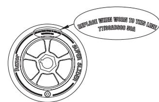
**1** Para sacar una rueda, retirar la tuerca autobloqueante (se necesita una llave de tubo o una llave de 13 mm para las ruedas delanteras y una de 17 mm para las ruedas traseras). Golpear ligeramente la rueda para quitarla.
