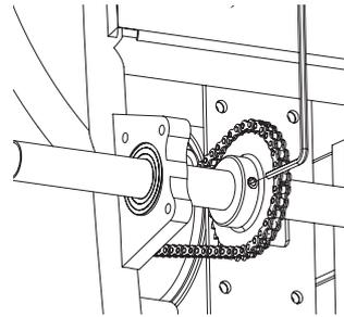
3 Usar una llave Allen de 3 mm para aflojar la rueda dentada.
