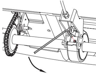
2 Usar una llave Allen de 3 mm para aflojar el freno.
