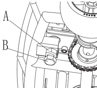
**1** Con una llave abierta de 16 mm, afloje la contratuerca del tornillo de la cadena (B) y apriete o afloje el perno de ajuste (A) para apretar o aflojar la cadena según sea necesario.
