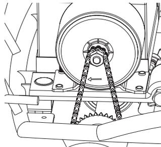
**2** Una vez que el ajuste sea bueno, mientras sujeta el perno de ajuste, vuelva a apretar la tuerca de seguridad de forma segura. Haga una prueba en Ground Force y reajuste según sea necesario.
