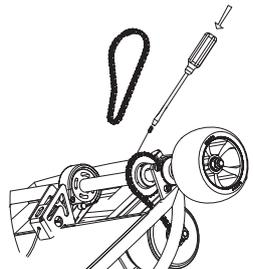
3 Con un destornillador de cabeza plana, vuelva a colocar con cuidado el clip en la placa de enlace. El clip debe apuntar en la dirección de desplazamiento de la cadena.
