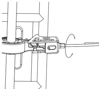
**1** Para ajustar el freno, girar el tensor de  $\frac{1}{4}$  a  $\frac{1}{2}$  giro hacia adentro o hacia afuera, hasta obtener el ajuste deseado del freno.
