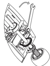
4 De ser necesario, afine la tensión de la cadena utilizando una llave abierta de 19 mm para ajustar el tornillo en el montaje del motor. Tenga cuidado de no apretar demasiado.
