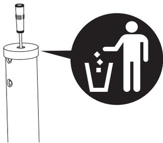
**1** Antes de insertar el manillar en el tubo de dirección, tire del conector y retire el protector de goma. Deseche el protector de goma.
