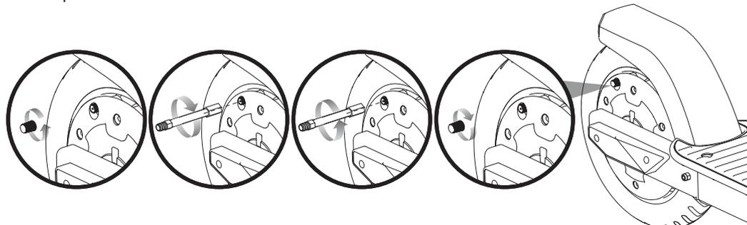
**1** Quite la tapa de la válvula e instale el adaptador de la válvula del neumático. Con una bomba de neumáticos tipo bicicleta equipada para una válvula tipo Schrader, infle el neumático trasero a la PSI correcta indicada en la pared lateral del neumático. Retire el adaptador y vuelva a colocar la tapa de la válvula.
