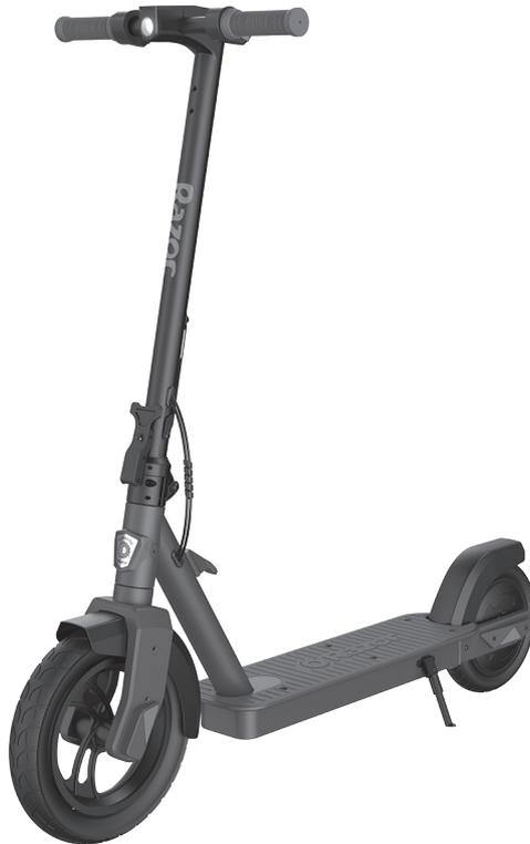
**⚠️NOTA:** La unidad debe viajar al menos a 5 km/h antes de que el motor se active. De un empujón para comenzar al menos a 5 km/h mientras aplica el acelerador para activar el motor.
