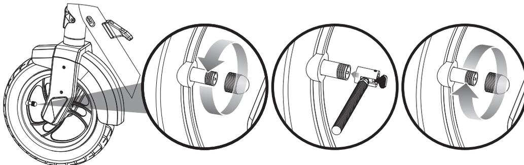
**1** Quite la tapa de la válvula y usando una bomba de neumáticos estilo bicicleta equipada para una válvula tipo Schrader, infle la llanta delantera a la PSI correcta indicada en la pared lateral de la llanta. Reemplace la tapa de la válvula.
