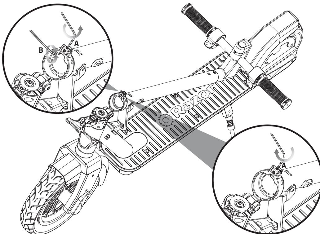
**1** Doble el scooter de acuerdo con las instrucciones del scooter plegable en la página 8. Con una llave Allen de 2,5 mm, afloje el tornillo A. Con una llave Allen de 2,5 mm ajuste el tornillo B.
