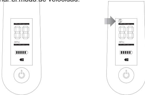
**1** La velocidad máxima del modo Bajo es de hasta 16 km / h.
