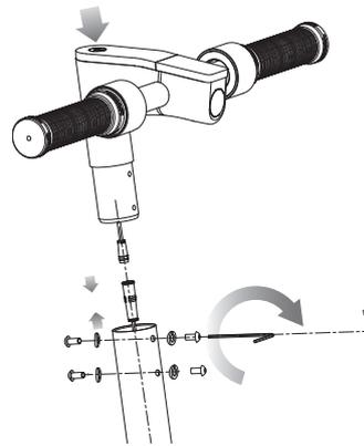
**3** Enchufe el conector. Deslice la potencia en el tubo de dirección. Tenga cuidado de no pellizcar el cable. Apriete los cuatro (4) tornillos y arandelas del manillar firmemente con una llave Allen S4.
