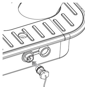
**2** Nota: asegúrese de que el botón de encendido esté en la posición APAGADO. Enchufe el cargador en el puerto del cargador. La luz del cargador debe ponerse roja durante la carga. La luz se volverá verde nuevamente cuando se complete la carga.
