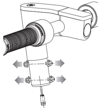
**2** Con una llave Allen S4, retire los cuatro (4) tornillos Allen y arandelas del manillar.
