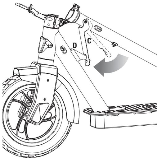
**2** Para usar el tubo de dirección como asa de transporte, despliegue el cerrojo del asa (C) y enganche el gancho del asa (D) en el marco.
