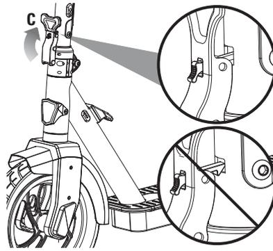
**2** Con el tubo de dirección en posición vertical, asegure el cerrojo plegable (C) presionando el cerrojo plegable para abrirlo contra el tubo de dirección para trabarlo en su lugar. Una vez asegurado, tire del cerrojo plegable (C) para comprobar que está enganchado y bloqueado.
