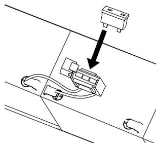
**3** Retire el fusible dañado o quemado y reemplácelo por uno nuevo de igual amperaje. Cierre la caja de fusibles
