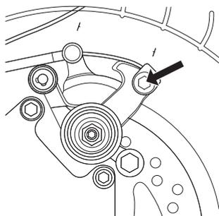
**2** Si el freno tiene demasiada holgura, afloje el perno del anclaje posterior con una llave Allen de 5 mm y tire del cable de freno mayor. La distancia del cable de freno entre el extremo del cable y el perno de anclaje debe estar entre 37 y 44 milímetros.
