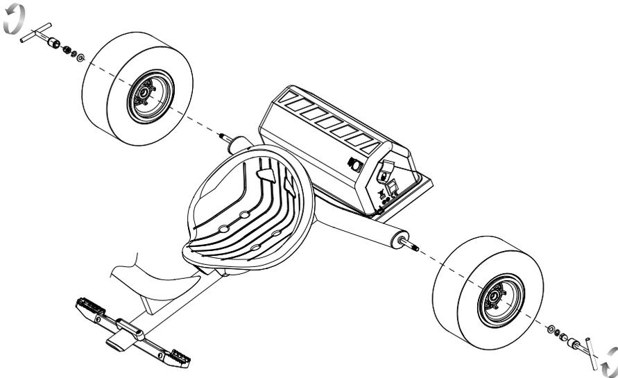
**2** Instale la (s) rueda (s) de reemplazo y apriételas firmemente en su lugar. Nota: la secuencia del hardware.
