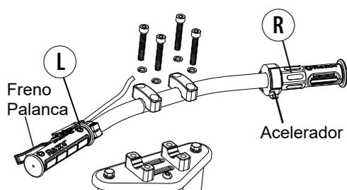
**1** Coloque el manubrio entre las abrazaderas del manillar superior e inferior.
