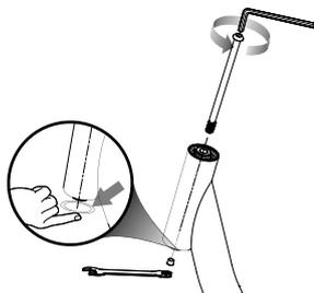
**1** Con una llave Allen de 5 mm y una llave de 13 mm, quite el perno de dirección y la contratuerca del tubo inferior.
