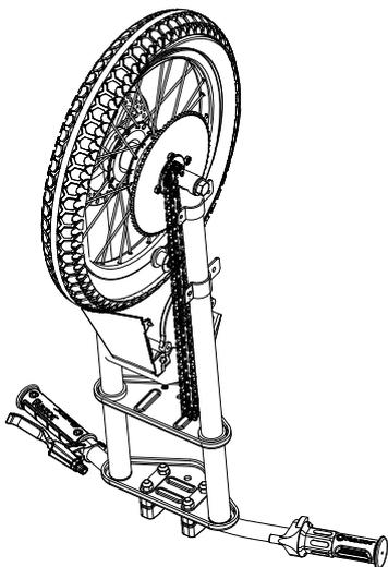
**3** Retire la cadena de alrededor de la rueda dentada en la rueda delantera.
