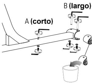
**1** Usando dos (2) 5 mm Llaves Allen, retire los tres (3) pernos de acoplamiento del tubo inferior. Retire y deseche el inserto de plástico
