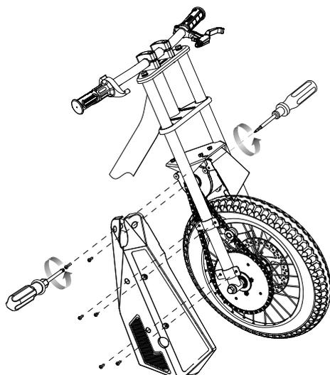
**1** Con un destornillador Phillips, afloje los siete (7) tornillos en el protector de la cadena.
