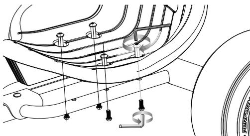
**2** Coloque el asiento en la posición deseada. Alinee los cuatro (4) agujeros en el asiento con los agujeros en el marco. Vuelva a insertar los pernos de acoplamiento y apriete los pernos hasta que el asiento esté firmemente en su lugar.
