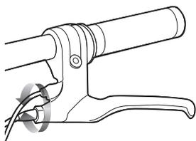
**1** Para ajustar el juego de cable de freno, rosca el Ajustador de la palanca de freno de 0 a 1/4 a 1/2 vuelta hasta que se logre el ajuste de los frenos deseada. Ajustes la mayoría están completos en este paso. Si freno todavía necesita ajuste, proceda al paso 2.
