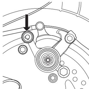
**3** Si el rotor del freno se prolonga las almohadillas de freno, use sus dedos para enroscar al ajustador del calibrador en la una o la otra dirección hasta que el rotor sea centrado entre almohadillas.
