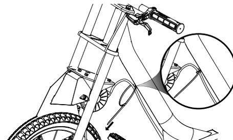
**6** Use una brida de sujeción para evitar que los cables se froten contra la rueda delantera cuando la unidad está en movimiento.
