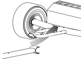
**2** Conecte el tubo descendente al marco trasero y alinee los orificios en el tubo inferior con los orificios en el marco trasero.
