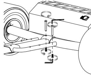
**3** Vuelva a insertar los dos (2) pernos de acoplamiento más largos (B) a través del tubo descendente y el bastidor trasero y apriételos firmemente en su lugar.
