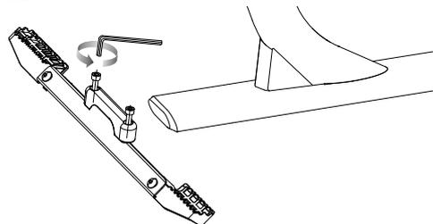
**1** Con una llave Allen de 5 mm, afloje los dos (2) pernos de acoplamiento en las clavijas del pie.
