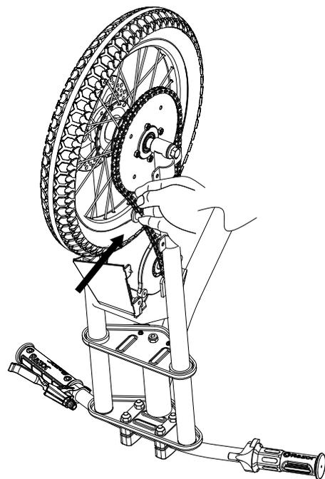
**6** Vuelva a colocar la cadena alrededor de la rueda delantera y el piñón del motor.
