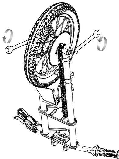
**4** Con una llave abierta de 15 mm y 19 mm, quite el perno del eje. Retire la rueda delantera.
