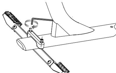
**2** Deslice las clavijas del pie en la parte delantera del tubo inferior, como se muestra, y apriete los pernos de forma segura.
