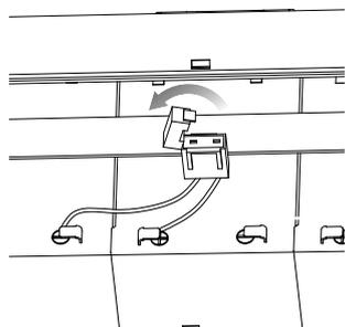
**2** Ubique la caja de fusibles en la parte superior de la batería. Abra la tapa del fusible para exponer el fusible
