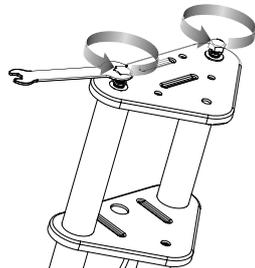
**2** Con una llave de 13 mm, afloje los dos (2) tornillos en la corona superior.
