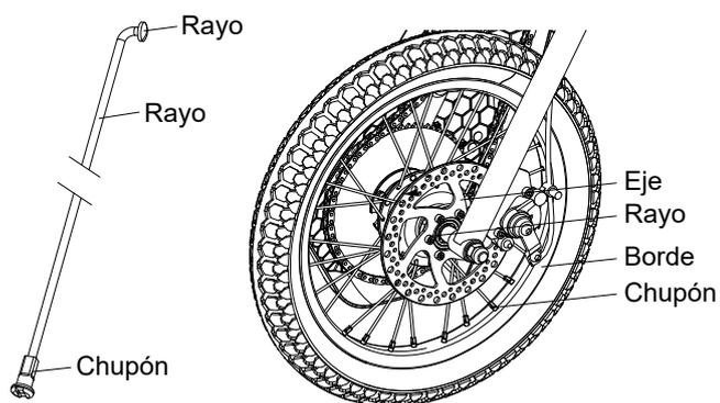
**1** Verificar la tensión de los radios agitando cada uno con sus dedos. El Radio no debe estar suelto en el cubo. Busque cualquier holgura entre el lugar donde el radio se adjunta al cubo. Intente girar el chupón con los dedos. No debería ser posible girar el chupón con la mano. Si uno o más radios está flojo, todos los radios deben verificarse y ser apretados con un llave de radio.
