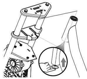
**3** Vuelva a insertar el casquillo inferior en el tubo descendente y luego deslice con cuidado el tubo descendente entre las coronas superior e inferior.
