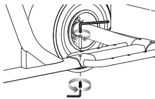
**4** Vuelva a insertar el (1) perno de acoplamiento más corto (A) a través del centro marco y tubo descendente y asegure en su lugar
