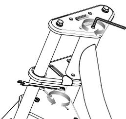
**4** Alinee el tubo inferior con el orificio en la corona superior e inferior y vuelva a insertar el perno de dirección. Apriete con cuidado con una llave Allen de 5 mm y una llave de 13 mm.
