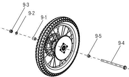
**5** Vuelva a instalar el perno del eje y apriete la rueda delantera de forma segura a la horquilla delantera.
