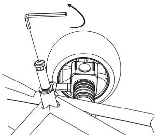
**1** Usando una llave Allen de 5 mm aflojar el tornillo ubicado en la columna de dirección.
