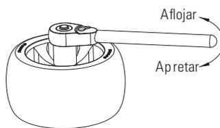
**1** Para sacar una rueda, retirar la tuerca autobloqueante (se necesita una llave de tubo o una llave de 13 mm para las ruedas delanteras y una de 17 mm para las ruedas traseras). Golpear ligeramente la rueda para quitarla.
