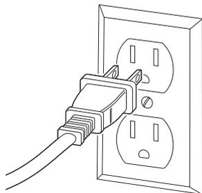
**2** Introducir el enchufe del cargador en la toma de corriente de la pared.
