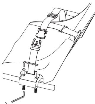
**1** Posicionar el asiento sobre el cuadro y alinearlo con los orificios del cuadro. Alinear los orificios de la fijación del cinturón de seguridad con los orificios del asiento y el cuadro con el conjunto de regazo y hombro a la izquierda y el broche hembra a la derecha. Introducir los tornillos y apretarlos bien.
