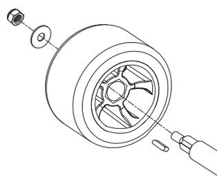
**3** Para sustituir una rueda trasera, asegurarse de que la espiga esté correctamente colocada en el eje trasero y alineada con la llave situada en la rueda. Posicionar la rueda con el logotipo de Razor mirando hacia afuera. Colocar la arandela y apretar bien la tuerca autobloqueante.
