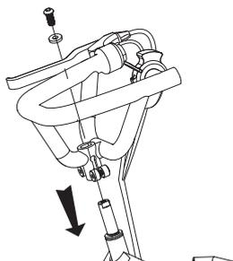
**2** Desenredar los cables. Introducir el volante, la arandela y el tornillo en la columna de dirección, como se muestra.
