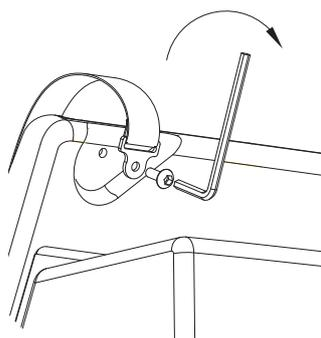
**2** Instalar la fijación del cinturón de hombro en el respaldo del asiento. Introducir y apretar bien.
