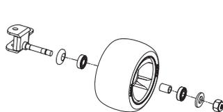
**2** Para sustituir una rueda trasera, asegurarse de que la espiga esté correctamente colocada en el eje trasero y alineada con la llave situada en la rueda. Posicionar la rueda con el logotipo de Razor mirando hacia afuera. Colocar la arandela y apretar bien la tuerca autobloqueante.
