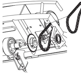
6 Cuando el extremo del eje esté separado del soporte de rodamiento, retirar y reemplazar la cadena. Para volver a montar, realizar el procedimiento a la inversa.
