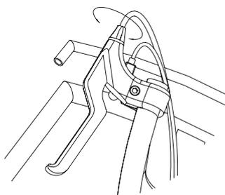
1 Para ajustar el freno, girar el tensor de  $\frac{1}{4}$  a  $\frac{1}{2}$  giro hacia adentro o hacia afuera, hasta obtener el ajuste deseado del freno.
