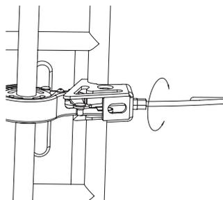
2 Si el tensor se gira hacia afuera y aun así, el freno tiene demasiada holgura, usar el tensor auxiliar del freno trasero, para efectuar un ajuste adicional.
