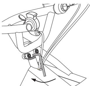
**4** Usando una llave Allen de 5 mm apretar de manera alternada cada uno de los pernos de la abrazadera del volante. Si los pernos están correctamente apretados, el espacio entre las dos mitades de la abrazadera será igual.
