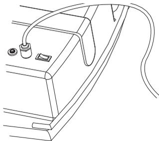
**1** Enchufar el cargador en el puerto de la Avalancha Eléctrica. Asegurarse de que el interruptor esté en posición **off**.
