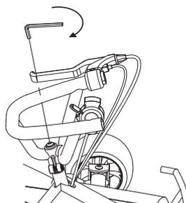
**3** Apretar bien el tornillo, usando una llave Allen de 5 mm
