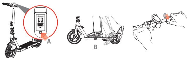
**Merk:** Den elektriske scooteren må ha en fart på minst 5 km/t mens du gir gass for å starte motoren.
