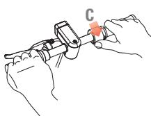
**Bemerk:** Den elektriske scooter skal køre m ed minimum 5 km/t samtidig med at man aktiverer gashåndtaget inden motoren slås til.
