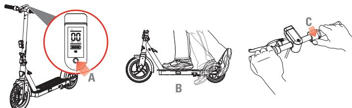
**Obs!** Den elektriska sparkcykeln måste rulla i minst 5 km/h när gasreglaget aktiveras för att motorn ska startas.
