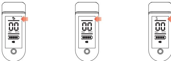
Stapvoets: maximaal 6 km/h, wordt aangeduid met één streepje bovenaan het display.
