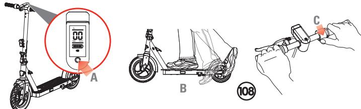
**ΣΗΜΕΙΩΣΗ:** Το ηλεκτρικό σκούτερ πρέπει να κινείται με τουλάχιστον 5 km/h (3 mph) όταν πατάτε το γκάζι για να ενεργοποιηθεί ο κινητήρας.
