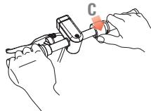
**Huom:** Sähköskootteri on liikuttava vähintään 5 km/h käytettäessä kaasua moottorin kytkemiseksi.
