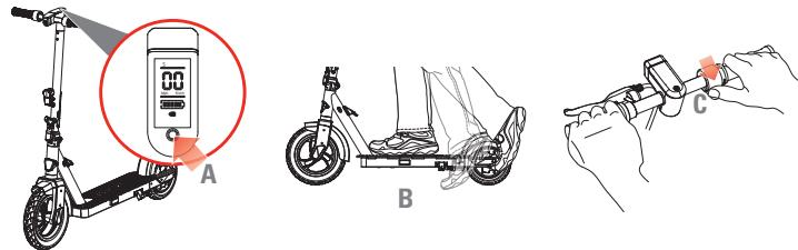
**Not:** Elektrikli scooter, motoru devreye sokmak üzere gaz kelebeğini çalıştırırken en az 5 km/s hızla hareket ediyor olmalıdır.
