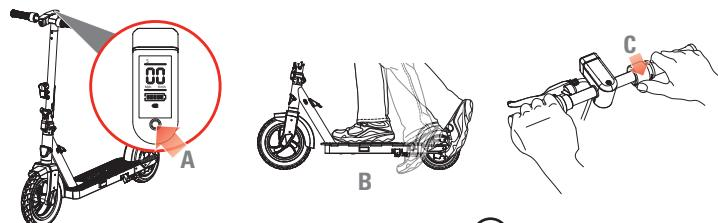
**Notă:** Trotineta electrică trebuie să se deplaseze cu o viteză de cel puțin 5 km/h în timpul cuplării accelerării, pentru cuplarea motorului.
