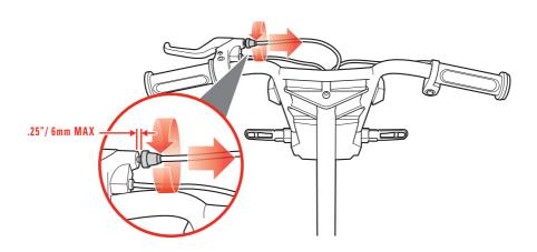
Tighten brakes at wire.公 紧固线芯处的刹车。
